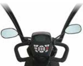
Specchietti retrovisori e cruscotto con schermo LCD e selettore modalità di guida
