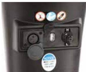
Selettore modalità di guida, presa per alimentazione e porta USB
