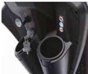
Selettore modalità di guida, presa per alimentazione e porta USB
