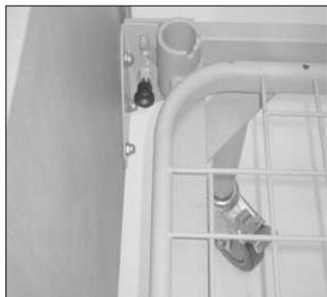
2. Inserire il telaio della testiera e della pediera nei supporti presenti sul telaio della rete facendo attenzione che il perno di bloccaggio si inserisca correttamente all'interno del foro (Fig.41). La testiera è quella con il cavo dell'attuatore più corto.
