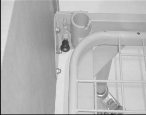
5. Inserire la testiera e la pediera in legno (sono due elementi uguali) nei supporti presenti sul telaio facendo attenzione che il perno automatico di bloccaggio si inserisca correttamente all'interno del foro (Fig.15)
