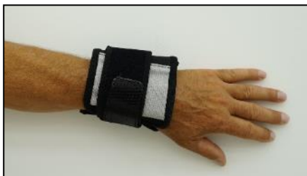
Esempio di posizionamento con solenoidi contrapposti
