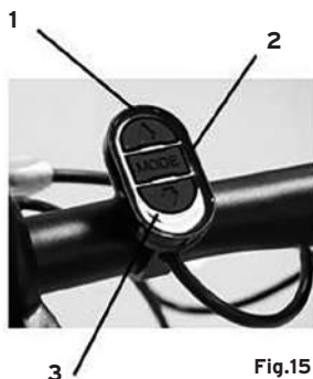
Definizione pulsanti di controllo delle funzioni del display
