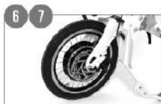
Ruota da 16" Con freno rigenerativo (EBS)
