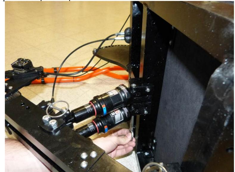
Montare le ruote sotto al sedile, inserendo il disco nella fessura del freno e bloccarle con gli appositi perni filettati:
