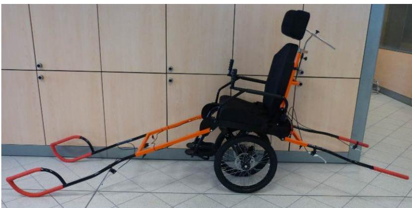
KBIKE è composto da una seduta larga 48 cm (a corredo è fornita una seconda seduta da 40 cm con spondine imbottite) ed è supportata da 2 ruote da 20" MTB montate ciascuna su un braccio ammortizzato per dare all'utilizzatore maggiore comfort durante le passeggiate.
