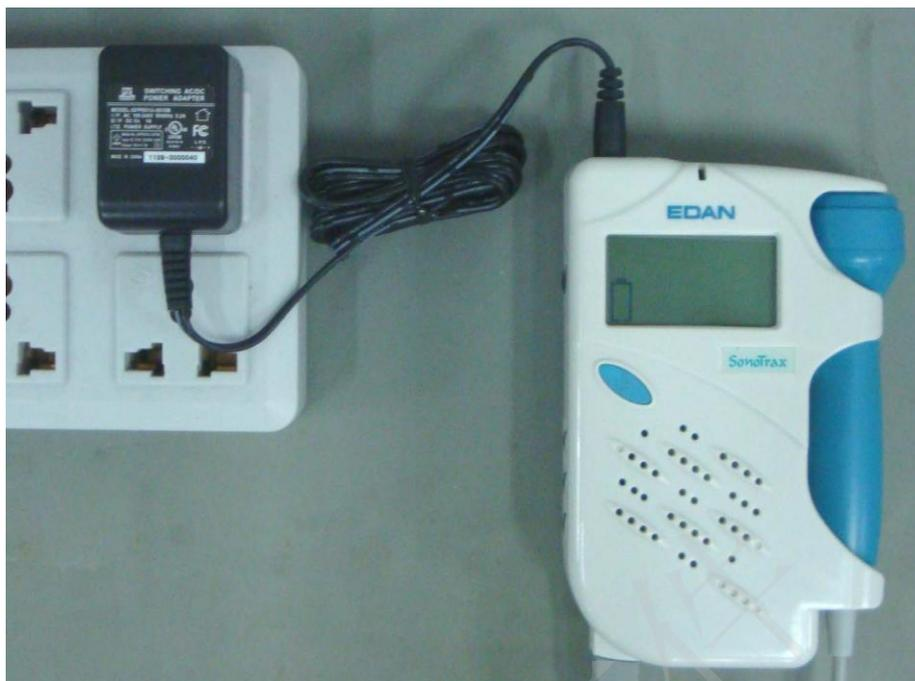
Figura 3-7 Ricarica del pacco batteria NI-MH
