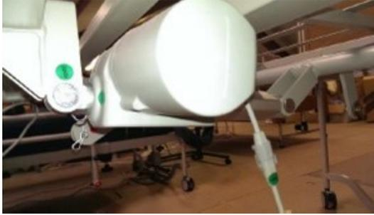
La centralina viene fornita già montata sul dispositivo di regolazione dello schienale con tutti i cavi codificati a colori. Accertarsi che il connettore sia collegato correttamente al corrispondente dispositivo di regolazione. I dispositivi di regolazione sulla testiera e sulla pediera devono essere collegati utilizzando i connettori con gli adesivi di colore giallo.
