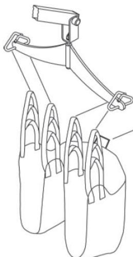
Fig. 1 Imbracatura universale (In dotazione)
