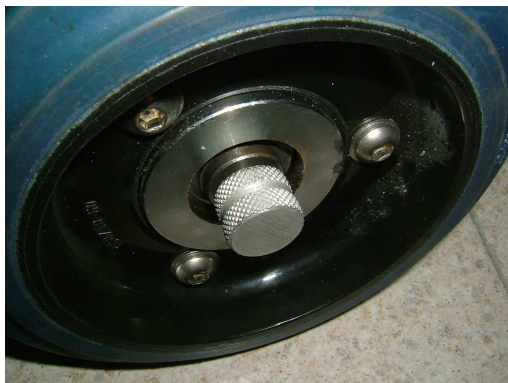
Perno inserito per l'utilizzo della trazione con il joy-stick
