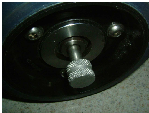
Perno estratto per l'utilizzo della trazione manuale
