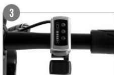
3 Acceleratore e indicatore livello batteria
