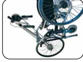
Applicazione dell' Easybike ad una carrozzina
